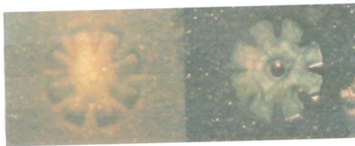
Figura 69 - Fabricação do protótipo de rotor r352020g4: à esquerda, o molde e resiste e, à direita, a estrutura de níquel.
